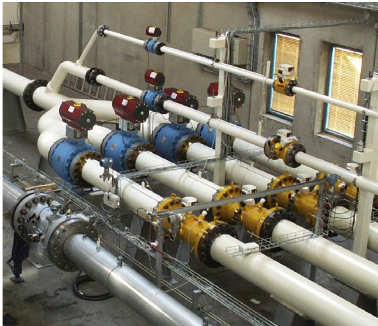
The National Reference Laboratory Force Technology, Вейен, Дания. Калибровка измерителей газового потока.
