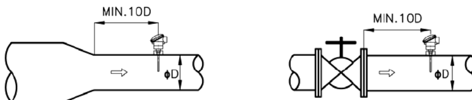
Tubería con reducción de paso / Pipes with reduced bore
